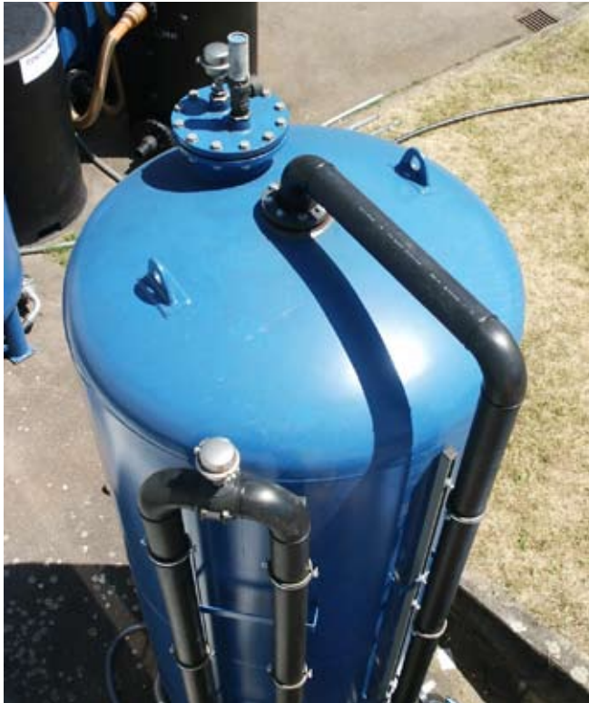
Rückseite der Kompaktstripanlage mit Revisionsöffnungen und Abluftverrohrung
