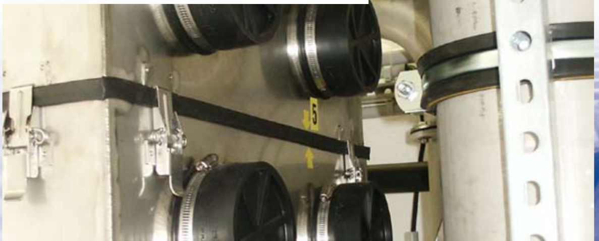
Rückseite der Kompaktstripanlage mit Revisionsöffnungen und Abluftverrohrung
