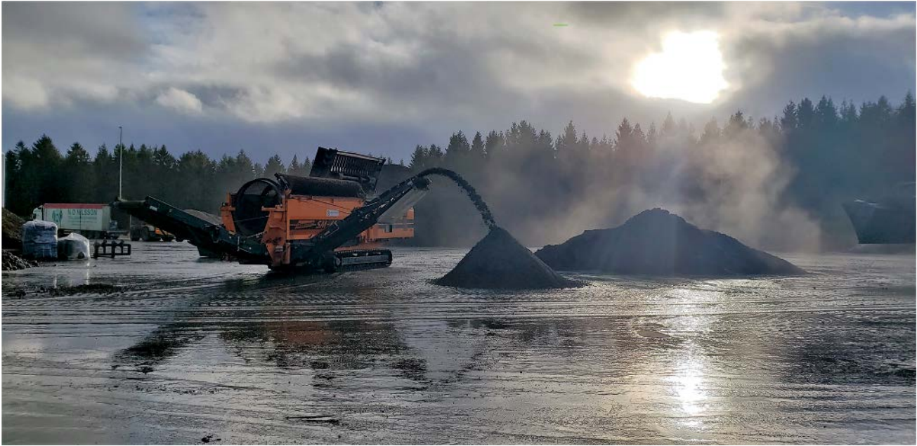
Abbildung 3: Siebtrommelanlage zur Behandlung von kontaminiertem Erdreich in einem Immobilisierungsprojekt in Schweden (Bild: EnvyTech) [9]
