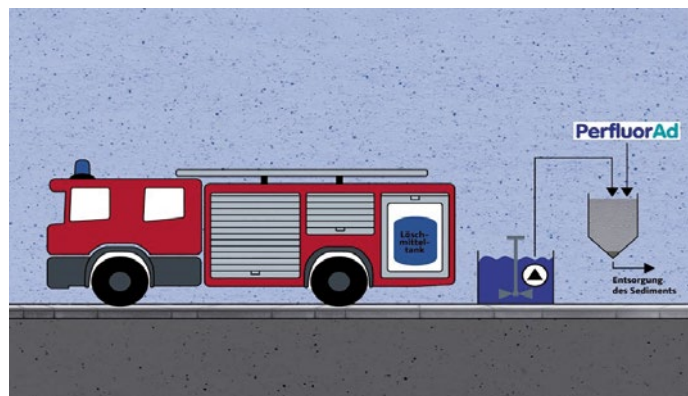
Schritt 3: Reinigung der angefallenen Spülwässer.
